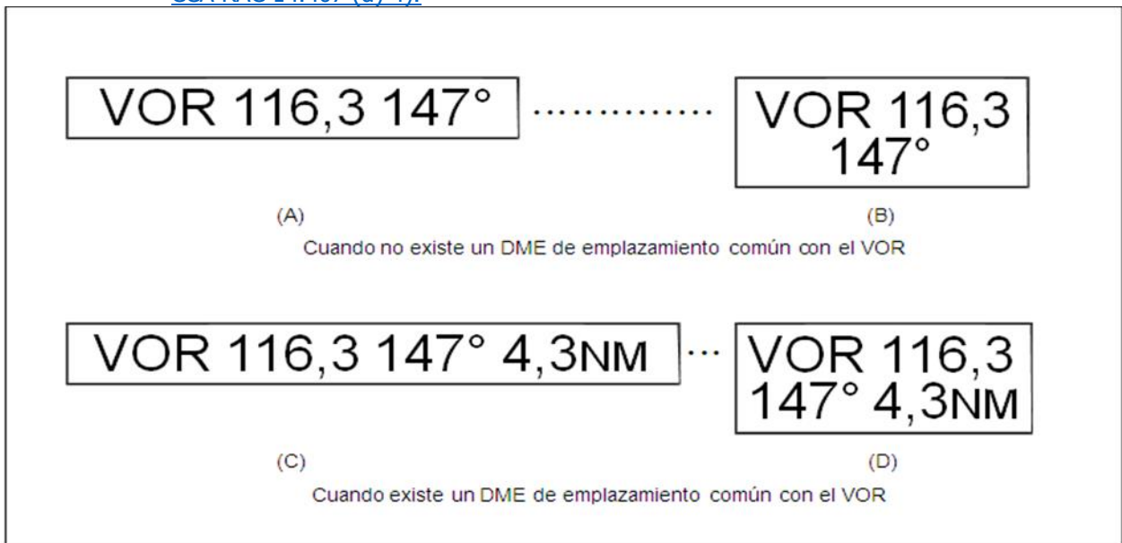
Figura E-33. Letreros de punto de verificación del VOR en el aeródromo
